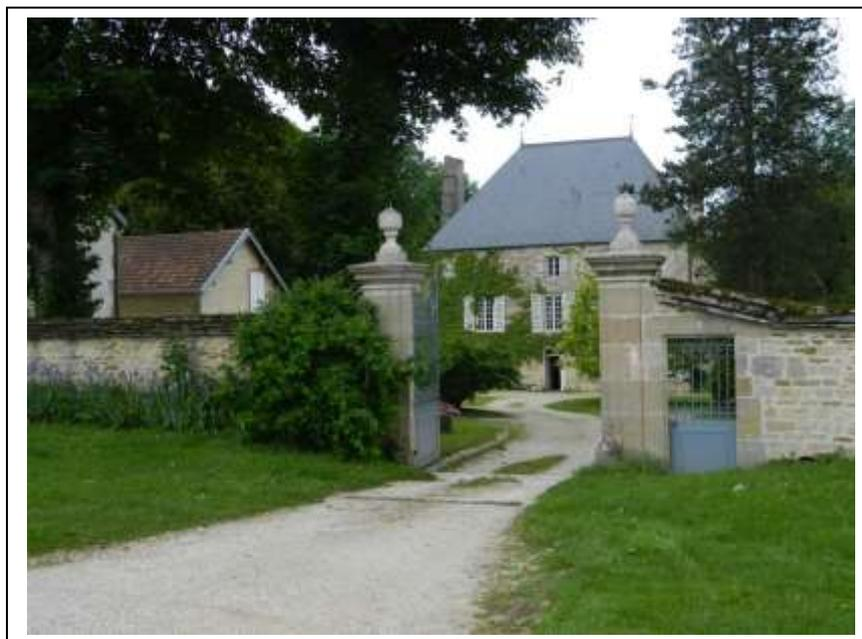
Les murs sont soit enduits, soit réalisés en pierre de taille appareillée. La modénature est très élaborée : corniche, bandeau, chaînage d'angle. Les ouvertures sont alignées à chaque niveau, ordonnancées et rythmées.
